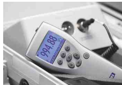
Ручной индикатор М170, показывающий преобладающее давление в гПа
