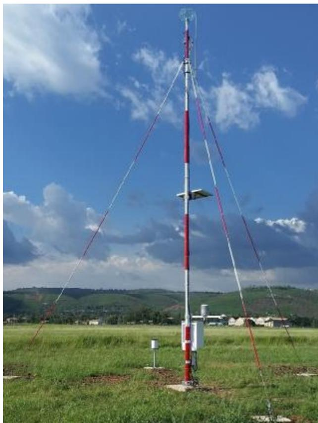
Рисунок 1 – Общий вид метеостанции AWS310-SITE
