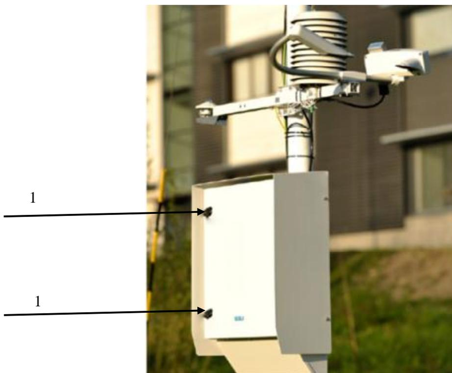
Рисунок 2 – Схема расположения замков на метеостанции AWS310-SITE
