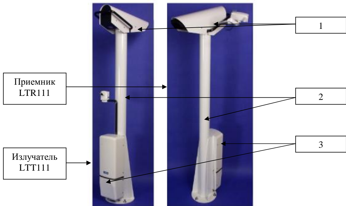
Рисунок 1. Трансиссометры LT31 1 - Измерительный блок, 2-мачта, 3-интерфейсный блок
