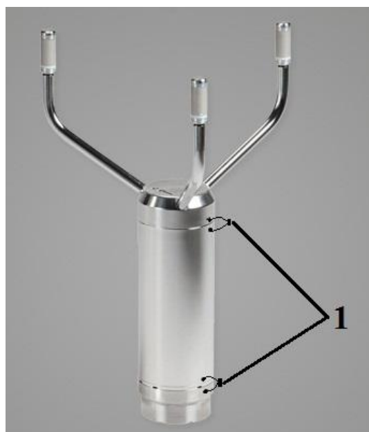
Рисунок 2. Схема пломбирования преобразователей WMT700. Пломбы на преобразователе – 1.
