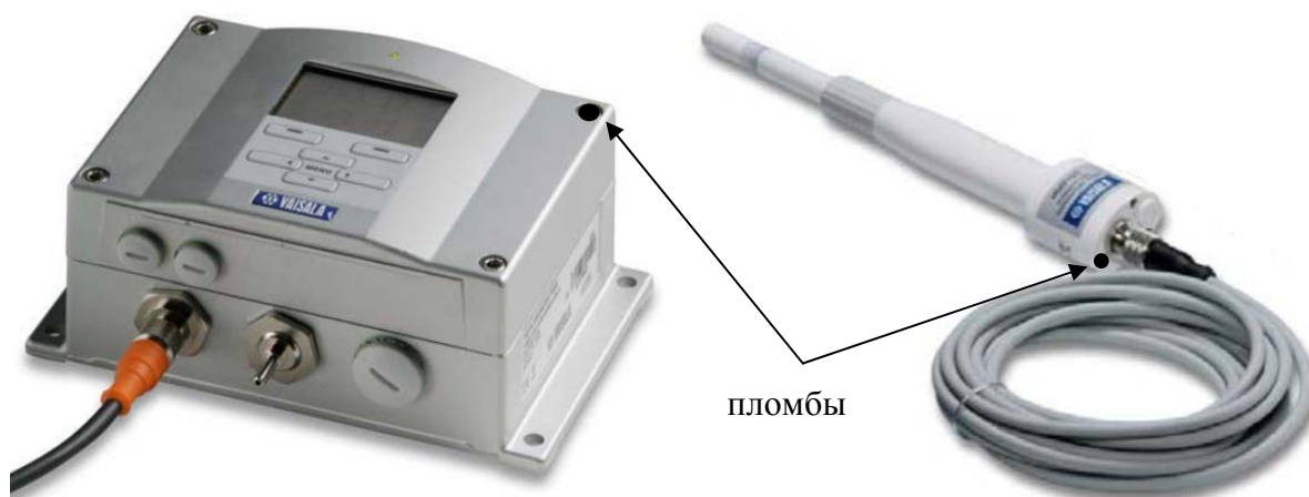
Рисунок 2 - Схема пломбирования барометров PTB330TS
