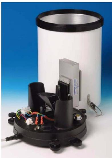
Датчик осадков RG13 состоит из корпуса и воронки из алюминиевого сплава с точно подобранной прокладкой сверху для создания отверстия 400 см<sup>2</sup>. Лоточный механизм на основе отливки из алюминиевого сплава смонтирован внутри корпуса.
