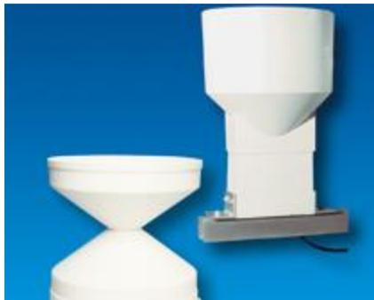
Осадкомер QMR101 представляет собой экономичный и точный дождевой осадкомер, изготовленный из пластика, морозоустойчивый и отличающийся высокой стойкостью к воздействию УФ излучения. QMR101 оборудован саморазгружающейся опрокидывающейся ложечкой емкостью 0,2 мм. Благодаря небольшому размеру, малому весу и прочной конструкции он особенно хорошо подходит для переносных решений и временной установки. QMR101 устанавливается на траверсу датчика и имеет готовый кабель с разъемом.
