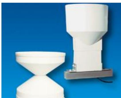
Осадкомер QMR102 представляет собой дождевой осадкомер аэродинамической формы, разработанный для минимизации воздействия ветра, снижающего объем улавливаемых осадков. Применение в изготовлении стойкого к УФ-излучению датчика делает осадкомер очень надежным инструментом. Собранный дождь измеряется в хорошо зарекомендовавшем себя механизме "опрокидывающегося ведра" емкостью 0,2 мм. QMR102 устанавливается в грунт или на дополнительную подставку, он поставляется с 6-метровым кабелем с разъемом.
